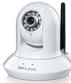
Cámara inalámbrica IP con movimiento Pan/Tilt infraroja. Mod. TL-SC4171G Cod. 0250006
