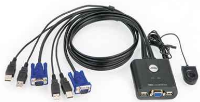
KVM mini switch 2 puertos USB con selector. Mod. CS-22U Cod. 0120009
